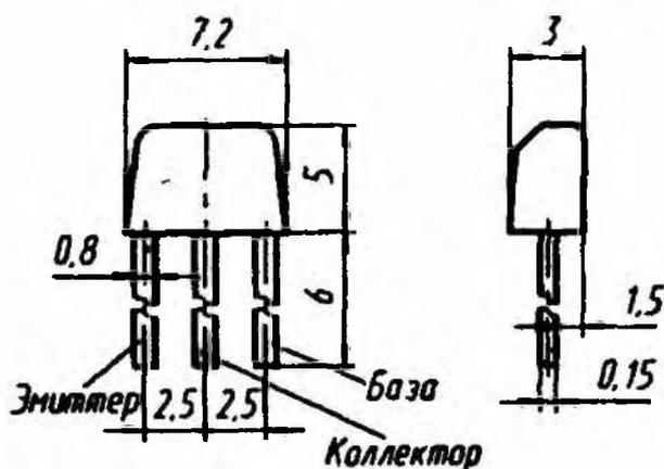
Транзисторы кремниевые эпитаксиально-планарные структуры  $p-n-p$  усилительные. Предназначены для применения в усилителях высокой частоты. Выпускаются в пластмассовом корпусе с гибкими выводами. Тип прибора указывается в этикетке.
