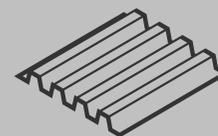
Ребристое основание позволяет крепить кабель-канал на клеевые растворы
